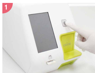
主電源、システム電源ON
