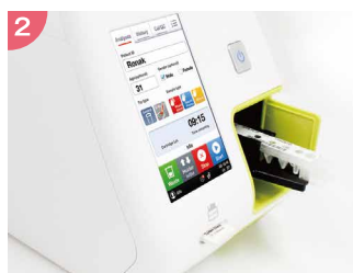
試薬カートリッジを挿入 (新ロット使用時にはIDチップも挿入)
